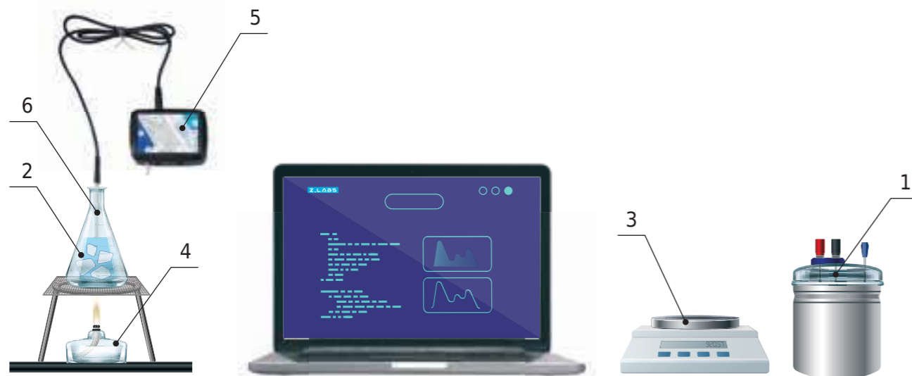
Схема эксперимента: 1 – калориметр, 2 – колба со смесью льда и воды, 3 – весы, 4 – спиртовка, 5 – мультидатчик, 6 – температурный зонд
