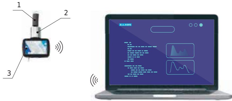
Схема установки: 1 - пружина, 2 - груз, 3 - датчик ускорения
