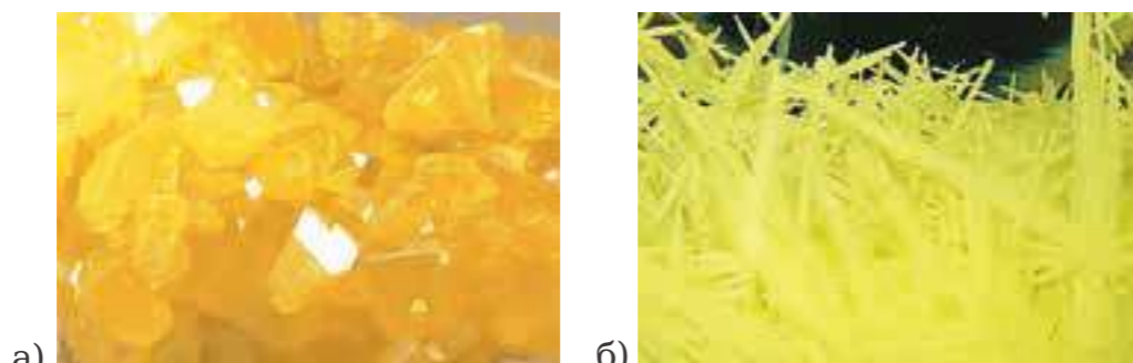
Рисунок 1. Кристаллы ромбической (а) и моноклиновой (б) серы
