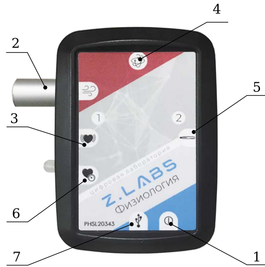
Рисунок 4.2.1. Беспроводной мультидатчик по физиологии: 1 - кнопка вкл./выкл. мультидатчика; 2 - трубка датчика частоты дыхания; 3 - датчик частоты пульса; 4 - датчик акселерометр; 5 - датчик температуры тела; 6 - датчик артериального давления; 7 - разъем питания и подключения к компьютеру
