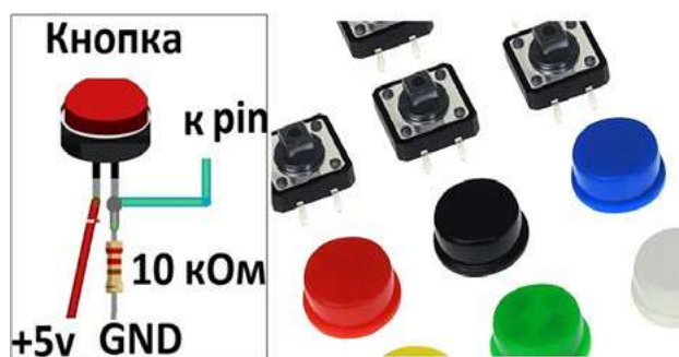
Рис. 1. Схема подключения тактовой кнопки к микроконтроллерной плате
